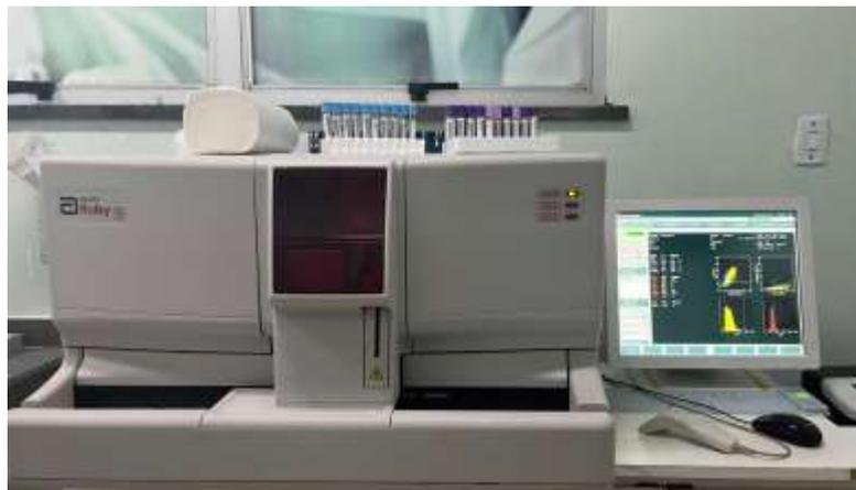
**Figura 8: Analisador hematológico Cell-Dyn Ruby.** Equipamento utilizado no laboratório de Análises Clínicas da FMT-HVD para obtenção do hemograma dos pacientes da referida instituição. (Fonte: CEPCLAM)
